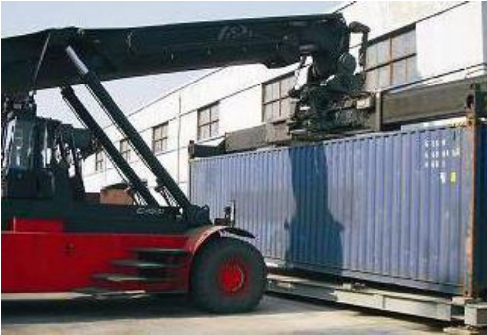
图2 检测仪正在对集装箱称量
